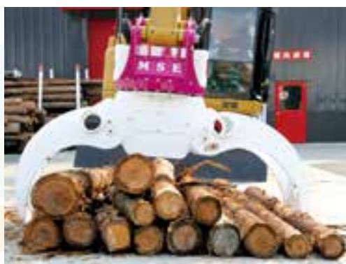
↑車体が傾いても、アームの先端は両側とも地面に接しています。(クランプ最大時)
